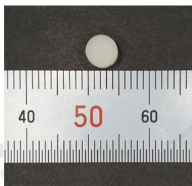
ภาพประกอบ 6 แสดงตัวอย่างชิ้นงานเซรามิกชนิดลิเทียมไดซิลิเกต
