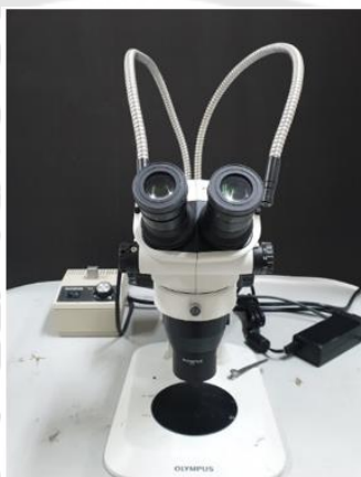
ภาพประกอบ 5 กล้องสเตอริโอไมโครสโคป(Stereomicroscope;SZ61,OLYMPUS Co.,LTD, Tokyo, Japan)
