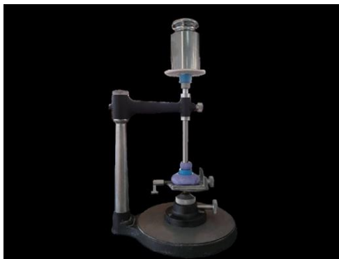
ภาพประกอบ 7 แสดงเครื่องสำรวจความขนานดัดแปลงด้วยตุ้มน้ำหนัก 1 กิโลกรัม
