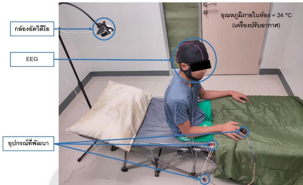
ภาพประกอบ 32 การติดตั้งอุปกรณ์ในการเก็บผลการทดลอง ซึ่งประกอบไปด้วย เครื่อง EEG กล้องอัดวิดีโอ และอุปกรณ์ที่พัฒนาขึ้น
