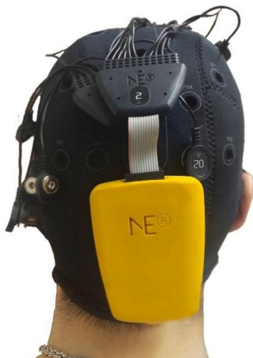
ภาพประกอบ 24 เครื่องวัดสัญญาณไฟฟ้าสมอง Neuroelectrics Enobio 20 (Commercial product)
