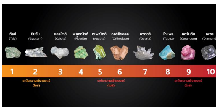
ภาพประกอบ 2 แสดงการจำแนกค่าความแข็งของแร่ในหน่วยโมลส์
