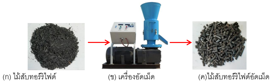
ภาพประกอบ 47 การแปรรูปจากไม้สับทอริไฟด์เป็นไม้สับทอริไฟด์อัดเม็ดโดยเครื่องอัดเม็ด
