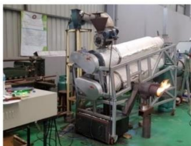
ภาพที่ 2: เครื่องปฏิกรณ์ผลิตเชื้อเพลิงทอริฟิเคชันแบบสกรูเอียง
