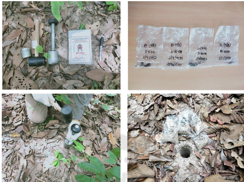
ภาพประกอบ 11 ขั้นตอนการเก็บตัวอย่างรากด้วยวิธีการ Soil Core
