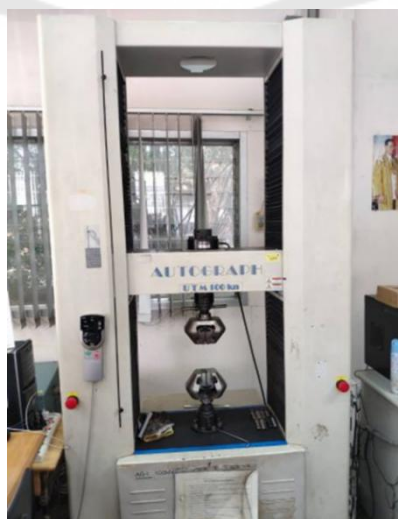
ภาพประกอบ 32 เครื่องทดสอบความแข็งแรง ยี่ห้อ SATEC รุ่น Autograph AG-IS 100kN
