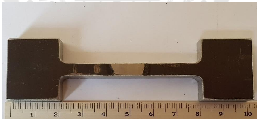
ภาพประกอบ 37 ชิ้นงานทดสอบความแข็งแรง มาตรฐาน ASTM E 8M
