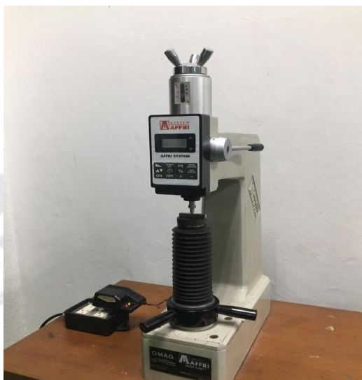
ภาพประกอบ 31 เครื่องทดสอบความแข็งแบบบริเนลล์ ยี่ห้อ AFFRI รุ่น BREVETTI
