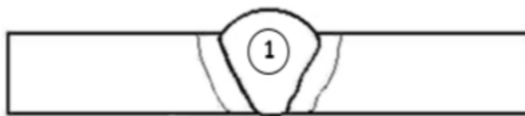
ภาพประกอบ 53 แสดงตำแหน่งตรวจสอบโครงสร้างจุลภาคบริเวณแนวเชื่อม (FZ)
