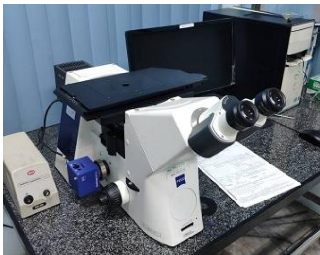
ภาพประกอบ 34 กล้องจุลทรรศน์แบบใช้แสง (OM) ยี่ห้อ ZEISS รุ่น Axio Observer 3 materials
