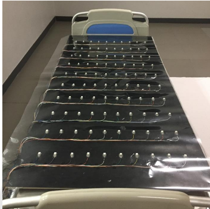
ภาพประกอบ 16 การคลุมเซ็นเซอร์แรงกดด้วย Protective sheet
