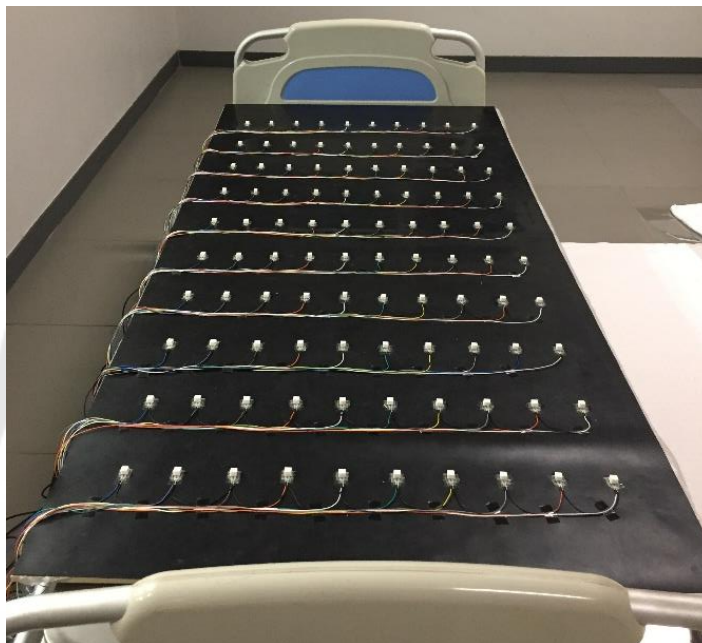
ภาพประกอบ 30 การติดตั้งเซ็นเซอร์แรงกดบนแผ่นยางพารา
