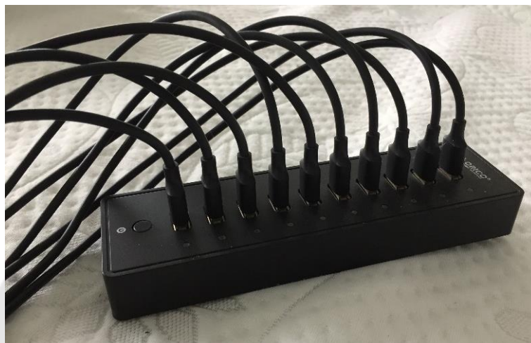
ภาพประกอบ 18 อุปกรณ์สำหรับนำส่งข้อมูลเข้าคอมพิวเตอร์ 10 port USB 3.0 hub
