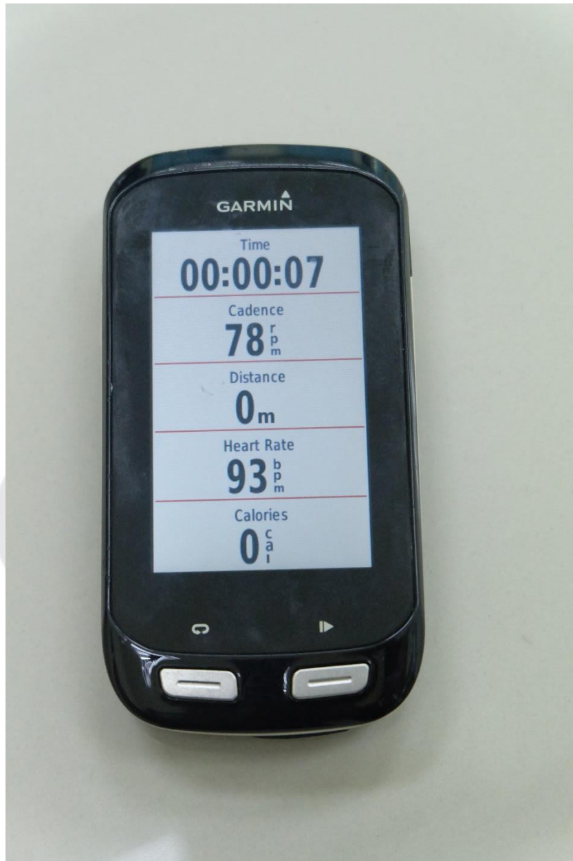
ภาพประกอบ 15 อุปกรณ์แสดงความเร็วและความเร็วรอบขา
