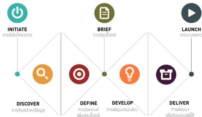
ภาพประกอบที่ 2 แผนภาพแสดงกระบวนการคิดเชิงออกแบบ ที่ Double Diamond Diagram
