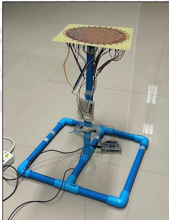
ภาพประกอบ 24 สายอากาศ สตัม และบอร์ดไมโครคอนโทรลเลอร์ที่เชื่อมต่อเข้าด้วยกัน
