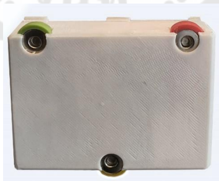
ภาพประกอบ 25 อุปกรณ์ติดตาม และบันทึกคลื่นไฟฟ้าหัวใจที่พัฒนาขึ้น
