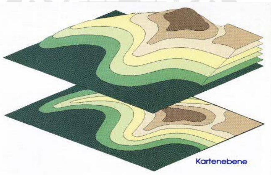
ภาพประกอบที่ 2 หลักการของเส้นที่แสดงชั้นความสูง
