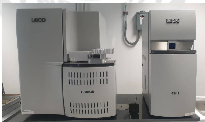
ภาพประกอบ 9 เครื่องวิเคราะห์องค์ประกอบแบบแยกธาตุ
