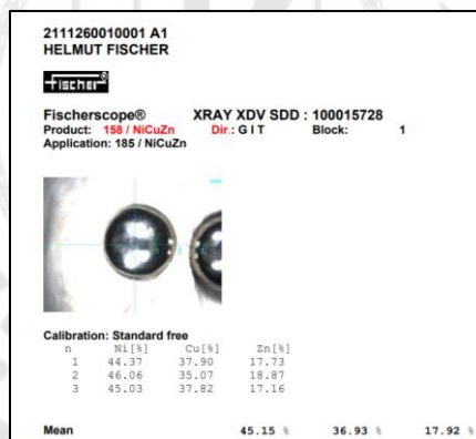
ภาพประกอบ 31 การวิเคราะห์องค์ประกอบทางเคมีของพรีอัลลอยด้วยเทคนิค X-ray fluorescence
