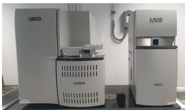
ภาพประกอบ 9 เครื่องวิเคราะห์ธาตุที่เป็นองค์ประกอบของสารอินทรีย์
