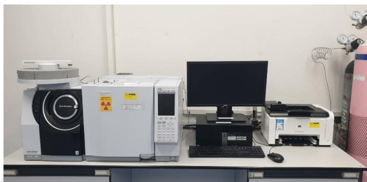
ภาพประกอบ 10 เครื่องแก๊สโครมาโทกราฟีแมสสเปกโตรมิเตอร์
