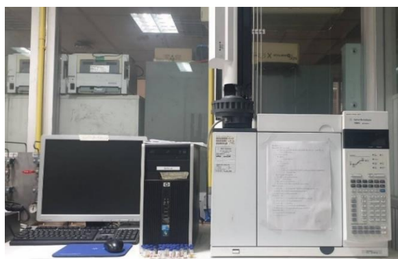
ภาพประกอบ 11 เครื่องแก๊สโครมาโทกราฟีจำลองการกลั่น
