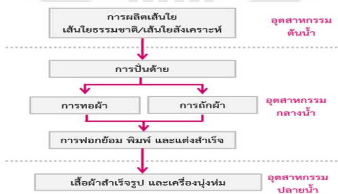
ภาพประกอบ 15 ภาพขั้นตอนการผลิตและอุตสาหกรรมสิ่งทอ
