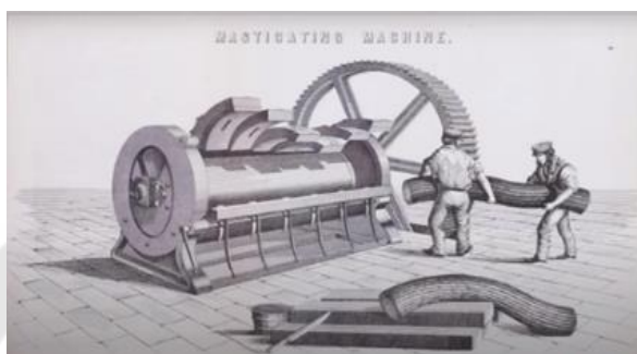
ภาพประกอบ 12 ภาพเครื่องฉีกยาง หรือ Masticator โดย โทมัส แฮนคอก
