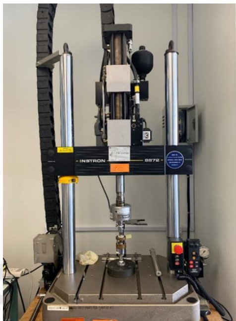
ภาพประกอบ 24 เครื่องทดสอบแรงดึงแรงอัดระบบไฮดรอลิก (Universal testing machine Instron 8872, Instron, UK)
