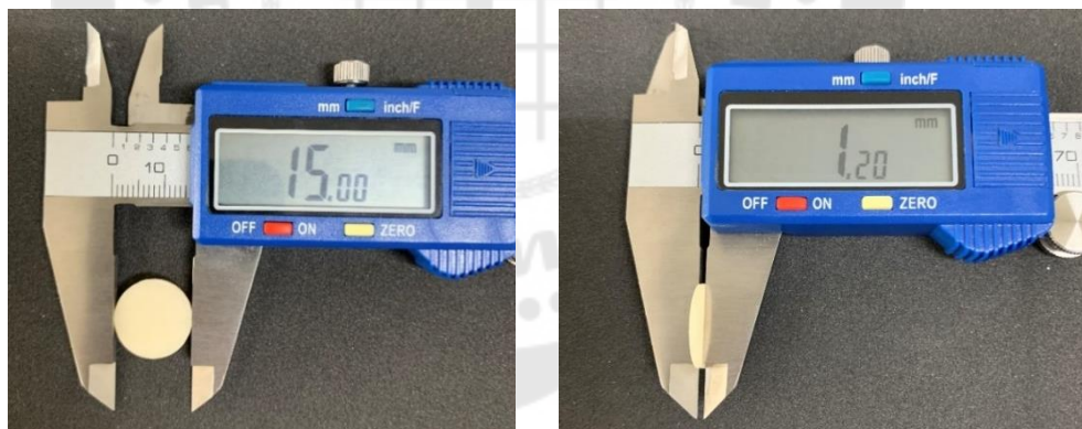
ภาพประกอบ 19 ขนาดของชิ้นงานวัดด้วยเครื่องวัดดิจิทัลไมโครมิเตอร์ (Digital micrometer; Park tool, USA)
