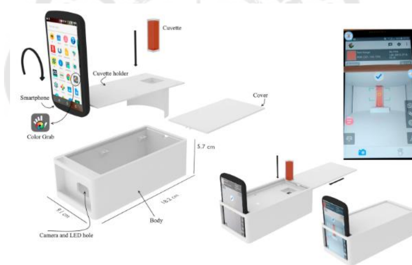
ภาพประกอบ 13 แผนภาพระบบวิเคราะห์ที่ประกอบขึ้นเพื่อให้ได้มาซึ่งภาพดิจิทัลในการหาค่า \text{Fe}^{3+} ในเชื้อเพลิงไบโอเอทานอล
