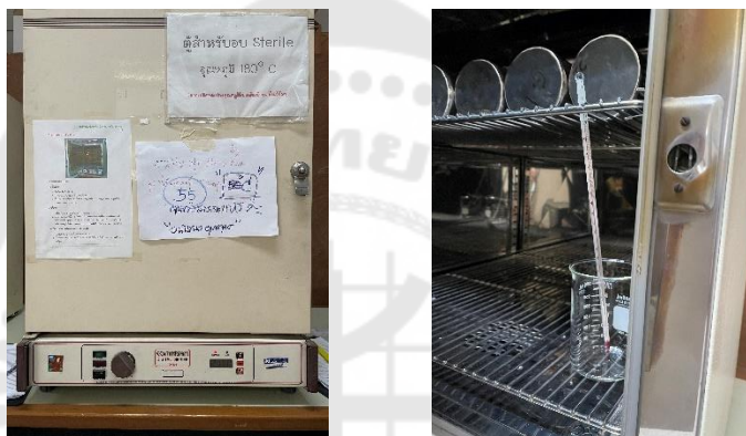
ภาพประกอบ 6 ตู้อบลมร้อนซึ่งภายในมีเทอร์โมคัปเปิลชนิดเควางอยู่
