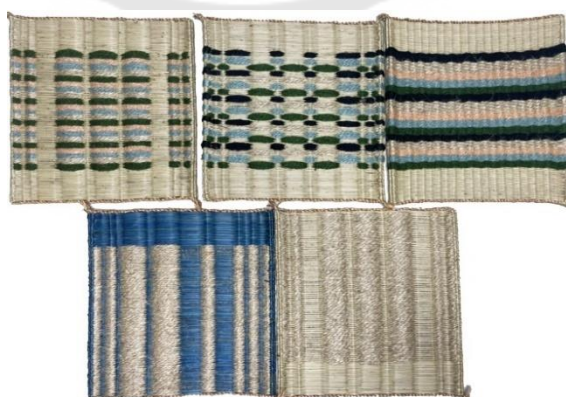
ภาพประกอบ 45 การทดลองการทอเสื่อกกผสมกับเชือกปอ และเชือกป่าน
