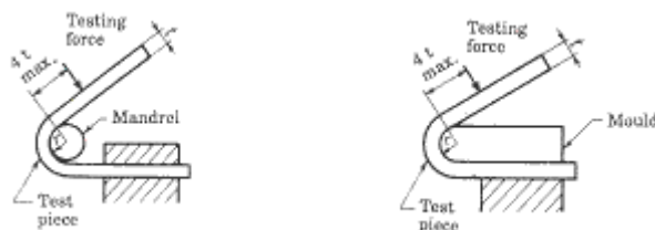
ภาพประกอบ 28 วิธีการทดสอบการดัดโค้งแบบ Winding bending method
