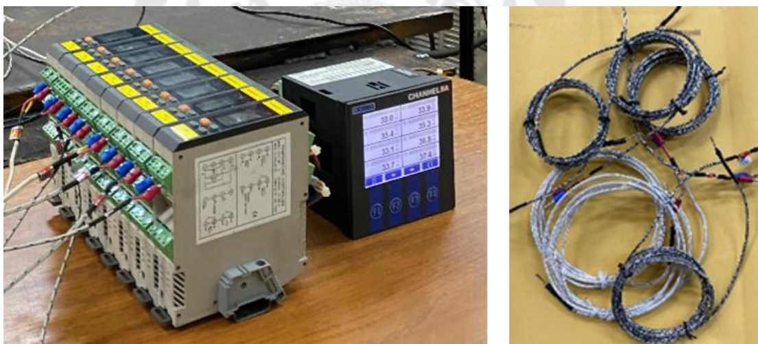
ภาพประกอบ 46 เครื่องเก็บบันทึกข้อมูลอุณหภูมิและเทอร์โมคัปเปิล K-type & R-type
