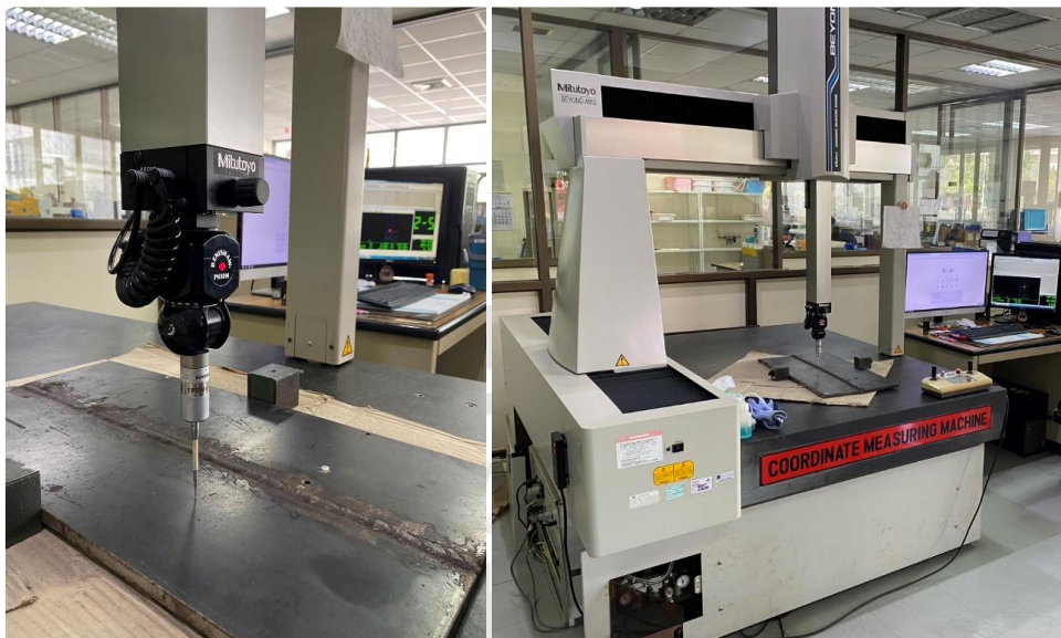
ภาพประกอบ 66 การวัดการบิดเบี้ยวของแนวเชื่อมโดยใช้เครื่อง Coordinate Measuring Machine (CMM)
