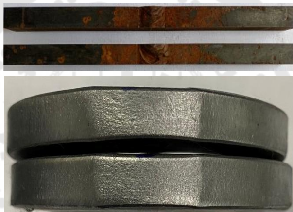
ภาพประกอบ 94 ผลการทดสอบการดัดโค้ง (Face bend) ของการเชื่อมแบบ GTAW และ SMAW
