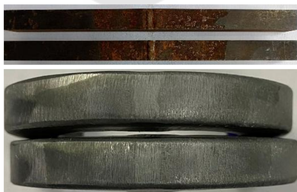
ภาพประกอบ 95 ผลการทดสอบการดัดโค้ง (Root bend) ของการเชื่อมแบบ GTAW และ SMAW
