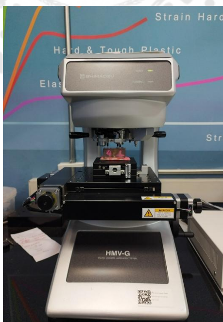
ภาพประกอบ 59 เครื่องทดสอบความแข็งวิกเกอร์ยี่ห้อ SHIMADZU รุ่น HMV-G
