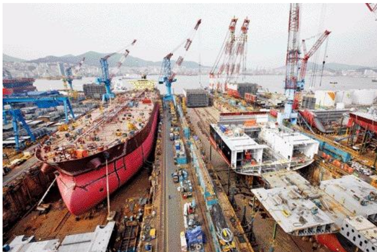
ภาพประกอบ 2 ตัวอย่างการประกอบสร้างตัวเรือในอุ้งต่อเรือ
