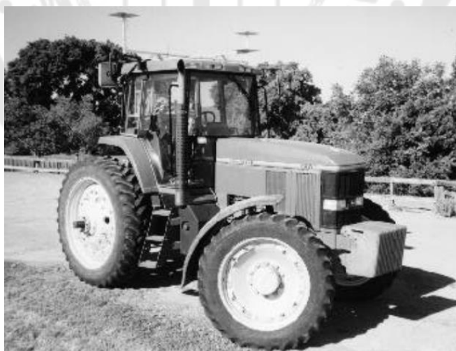
ภาพประกอบ 3 รถไถแบบไร้คนขับโดยตัวควบคุมการเลี้ยวแบบ CDGPS (O'Connor et al., 2000)
