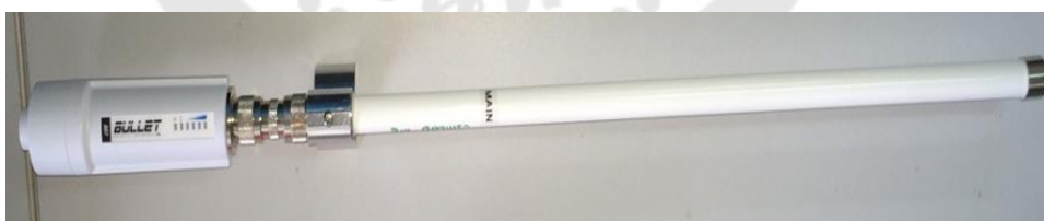
ภาพประกอบ 41 เสารับ-ส่งสัญญาณ เป็นของบริษัท Bullet รุ่น Bullet M2
