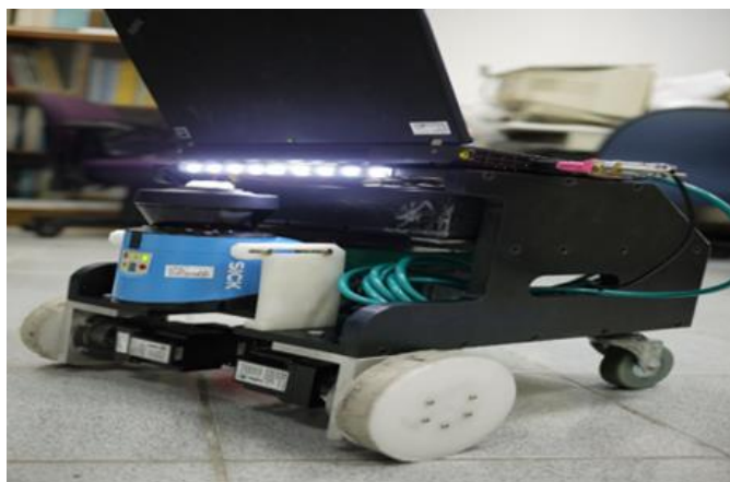
ภาพประกอบ 5 หุ่นยนต์เคลื่อนที่ติดตั้งเลเซอร์สแกนเนอร์ (Lo et al., 2014)
