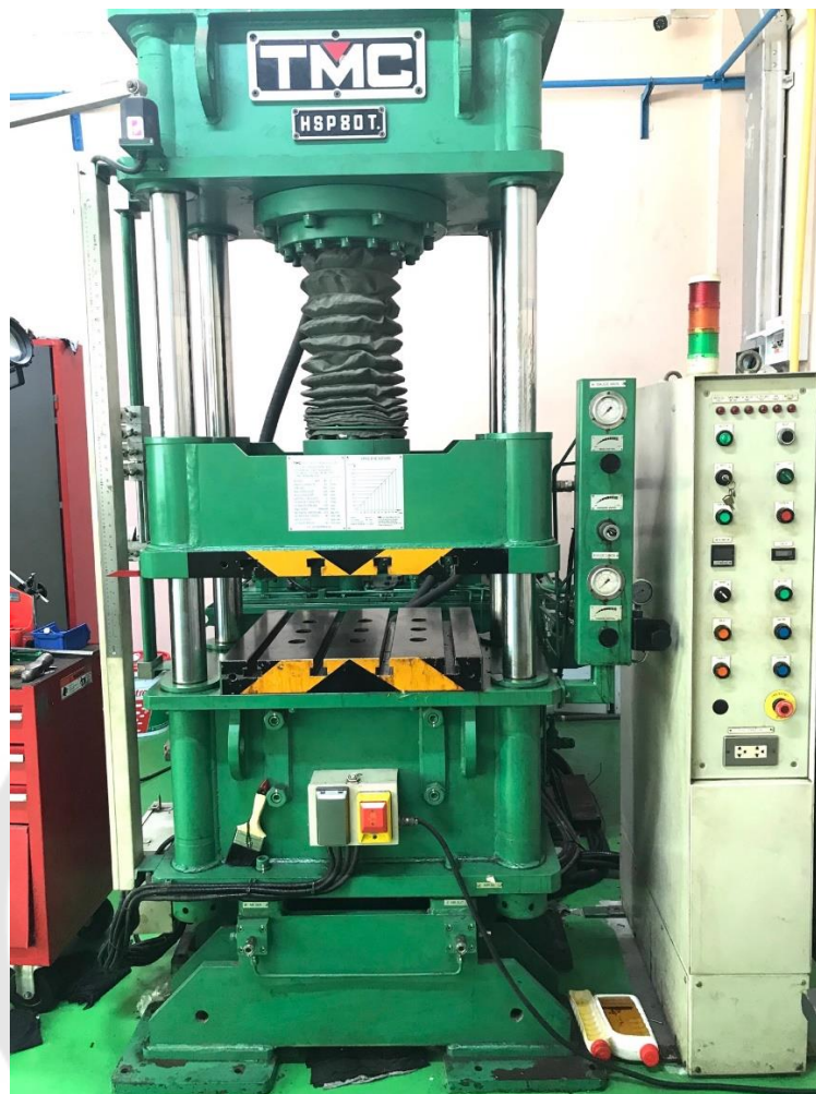
ภาพประกอบ 26 เครื่องเพรสแบบไฮดรอลิกขนาด 800 kN
