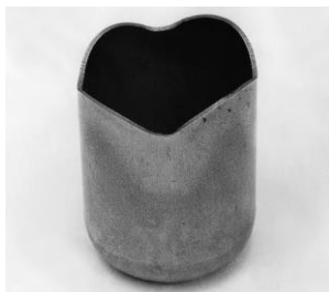
ภาพประกอบ 10 ความไม่เสมอกันของขอบชิ้นงานลากขึ้นรูป
