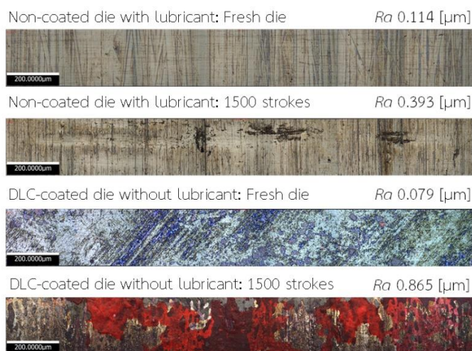
ภาพประกอบ 73 เปรียบเทียบลักษณะสภาพผิวของแม่พิมพ์ที่ใช้ขึ้นรูปวัสดุขึ้นงาน
