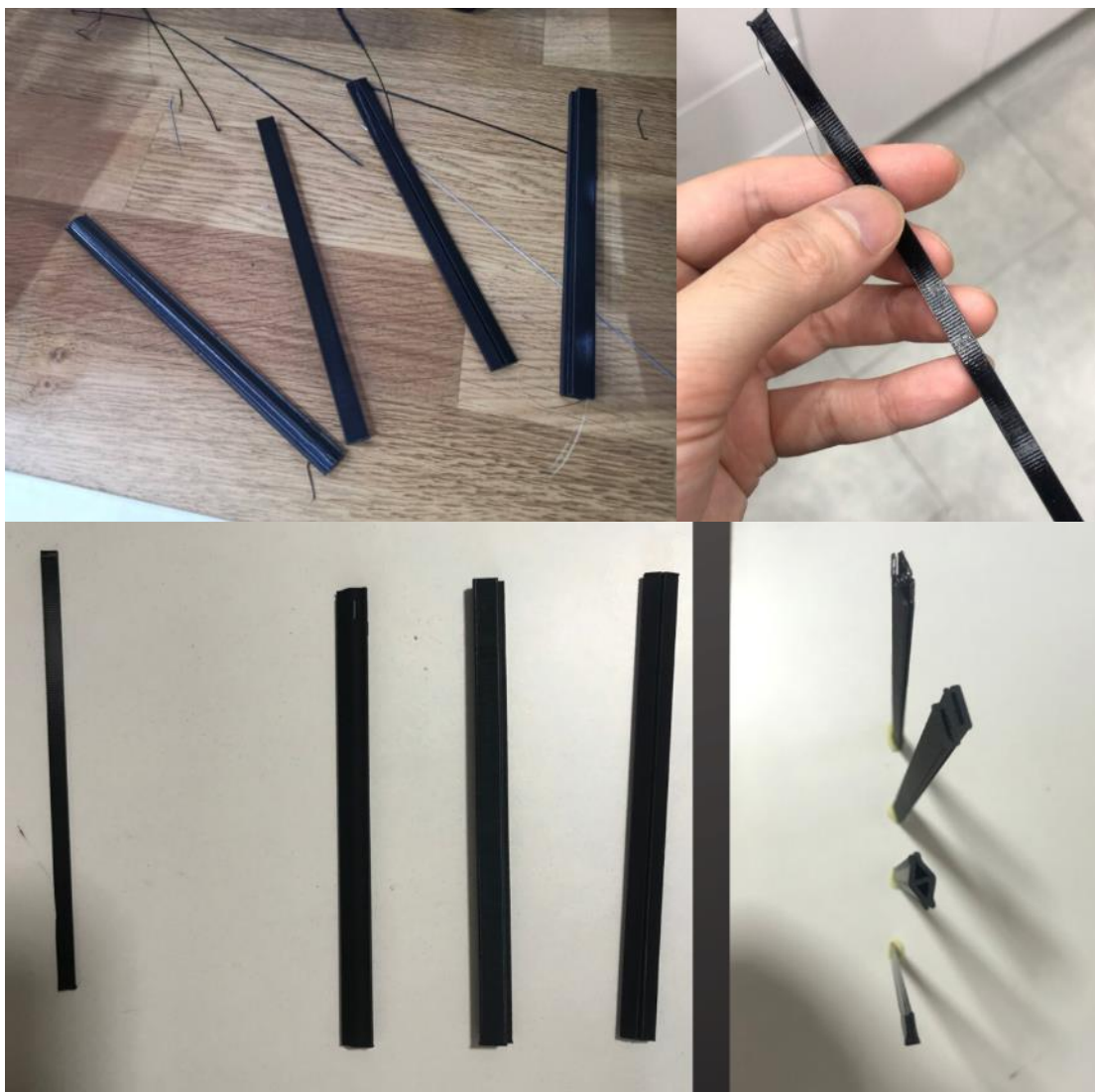
ภาพประกอบ 48 การขึ้นต้นแบบขื่อตอระบบโมดูลาร์ด้วยวิธีการพิมพ์สามมิติเพื่อทำการทดสอบ คุณสมบัติ
