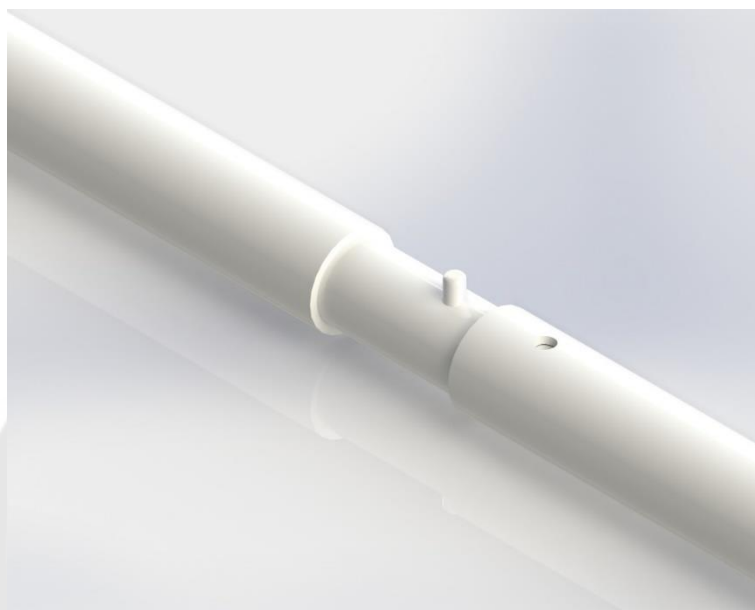
ภาพประกอบ 28 แสดงลักษณะข้อต่อแบบปุ่มกด ซึ่งล็อคตำแหน่งด้วยรู
