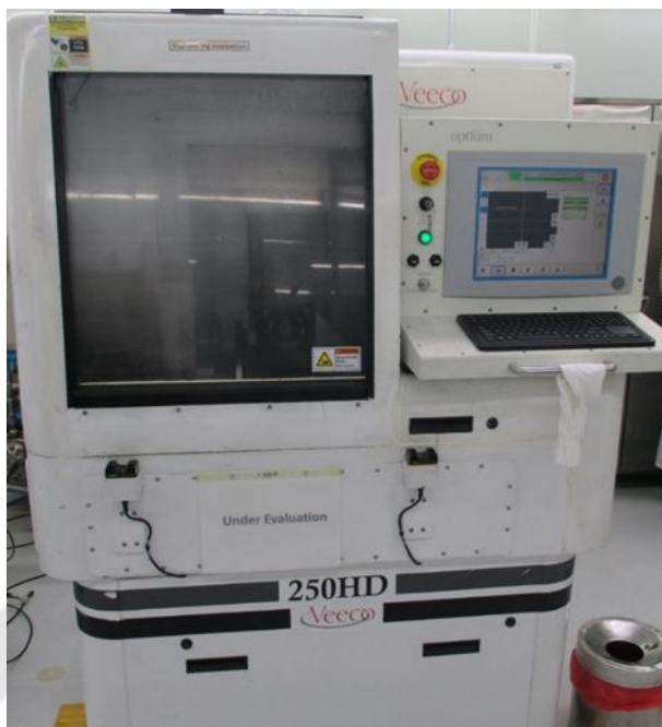
ภาพประกอบ 20 เครื่องตัดแบ่งสไลด์เดอร์ที่มีความแม่นยำสูง
