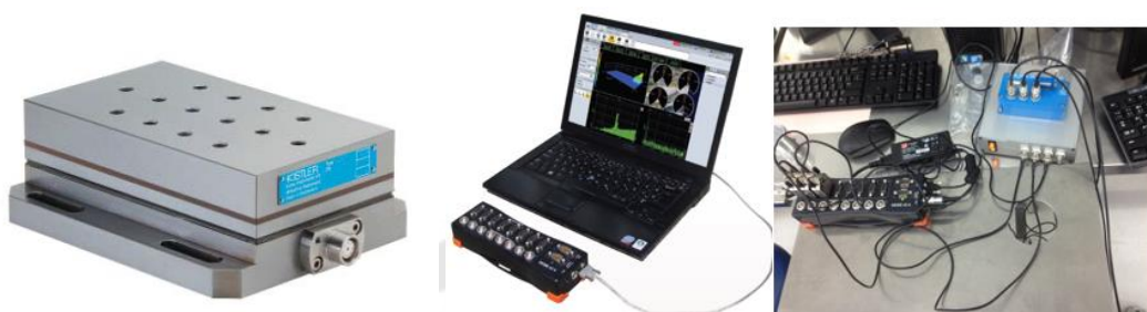
ภาพประกอบ 22 เครื่องสำหรับวัดแรง 3 แกน และอุปกรณ์ต่อพ่วงของเครื่องสำหรับวัดแรง 3 แกน
