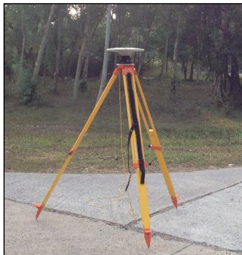
ภาพประกอบ 10 เครื่องรับสัญญาณดาวเทียมจีพีเอส Trimble รุ่น 5700 R7
