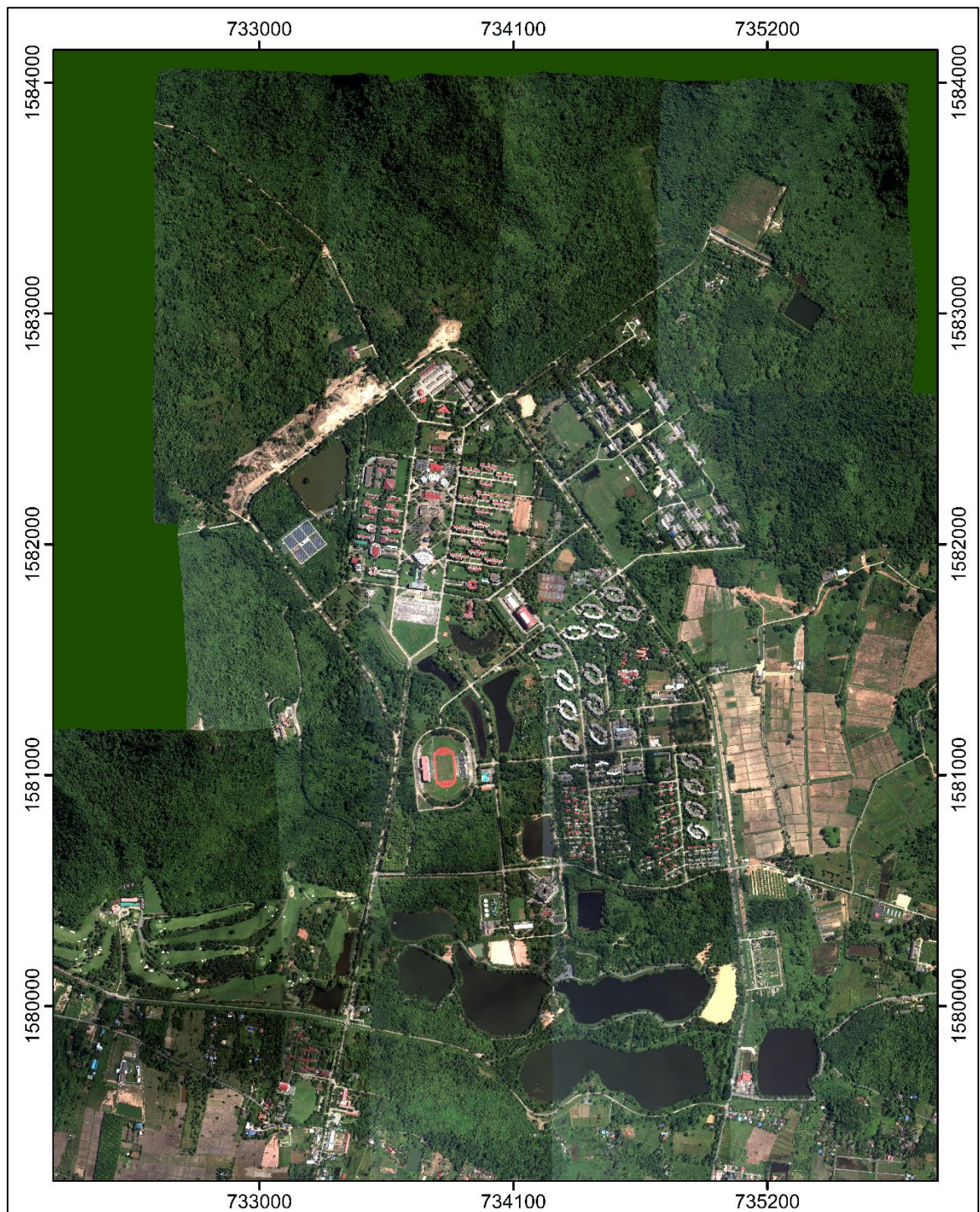
ภาพประกอบ 20 ภาพถ่ายออร์โธที่สร้างขึ้นโดยใช้จุดควบคุมภาพภาคพื้นดินด้วยวิธีการรังวัดแบบ ระบบเครือข่ายการรังวัดด้วยดาวเทียมแบบจลน์ในทันที
