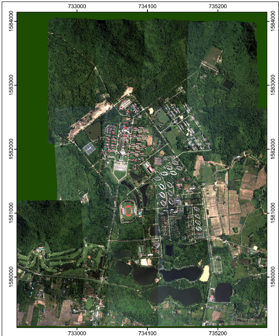
ภาพประกอบ 19 ภาพถ่ายออร์โธที่สร้างขึ้นโดยใช้จุดควบคุมภาพภาคพื้นดินด้วยวิธีการรังวัดแบบ สถิติ
