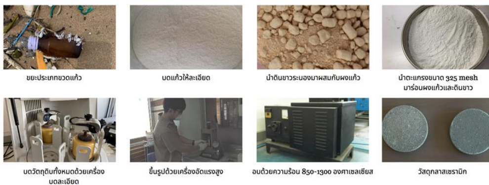
ภาพประกอบ 32 กระบวนการเตรียมและผลิตกลาสเซรามิกแบบแผ่นนี้
