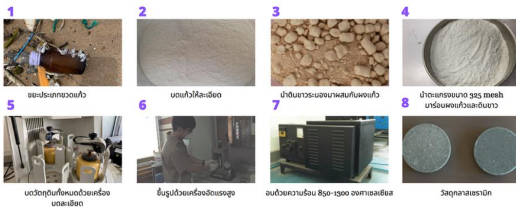
ภาพประกอบ 66 แสดงขั้นตอนในกระบวนการทดลองวัสดุกลาสเซรามิก
