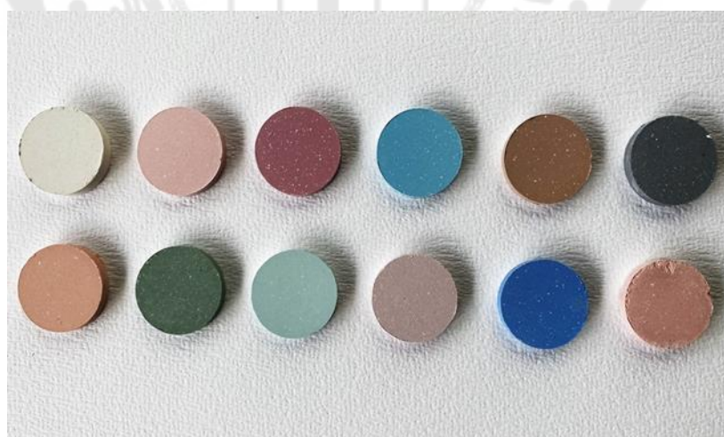
ภาพประกอบ 36 วัสดุกลาสเซรามิกที่ผ่านกระบวนการอัดด้วยเครื่องอัดไฮโดลิกและผ่านการอบด้วยอุณหภูมิ 90
