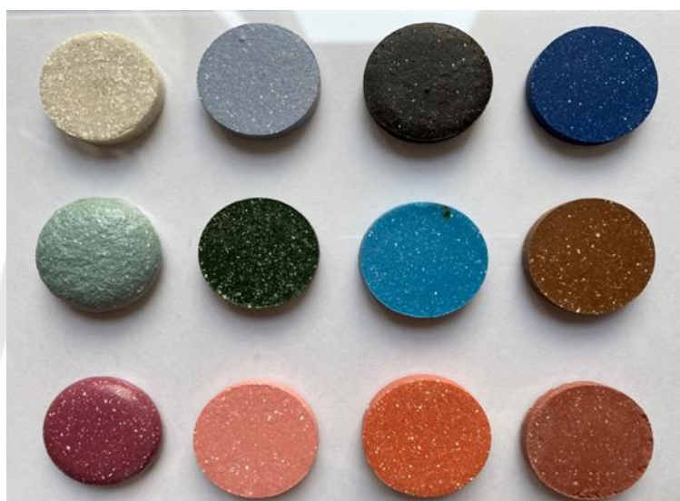
ภาพประกอบ 38 ทดลองวัสดุกลาสเซรามิกครั้งที่ 3 โดยใช้ชุดสีบ่งบอกถึงอารมณ์และความรู้สึก ของกลุ่มเจนเนอเรชั่น วาย โดยเผาที่อุณหภูมิ 1,250 องศาเซลเซียส
