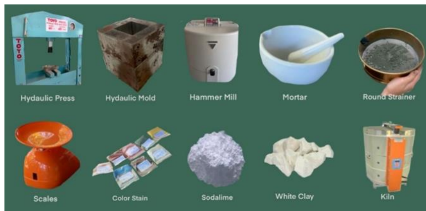
ภาพประกอบ 30 วัสดุและอุปกรณ์สำหรับผลิตกลาสเซรามิก
