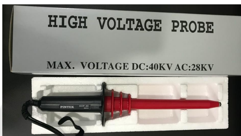
ภาพประกอบ 36 PROBE วัดแรงดันตกคร่อม VOLTAGE TESTER รุ่น HV-40
