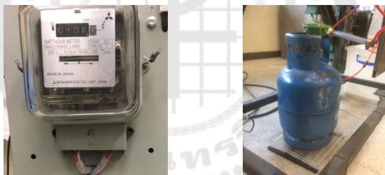
ภาพประกอบ 38 การบันทึกข้อมูลการใช้ไฟฟ้าและน้ำหนักเชื้อเพลิงที่ลดลง
