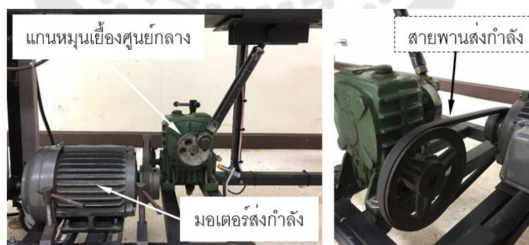
ภาพประกอบ 29 ชุดบังคับการเคลื่อนตัวของเมล็ดพืช (eccentric set)
