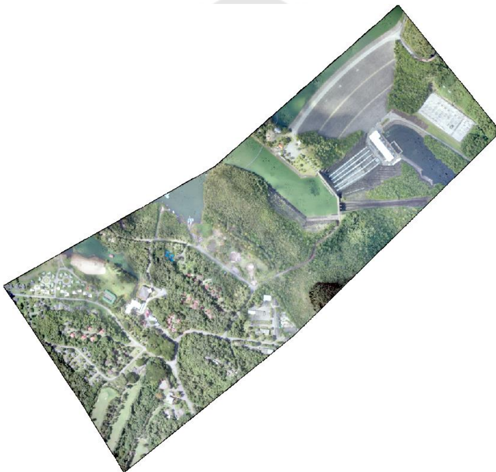
ภาพประกอบ 45 ภาพถ่ายออร์โธจากอากาศยานไร้คนขับที่ความละเอียดจุดภาพบนพื้นดิน (GSD) 0.06 เมตร
