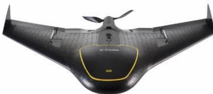
ภาพประกอบ 15 อากาศยานไร้คนขับแบบปีกตรึง (Fixed-wing)
