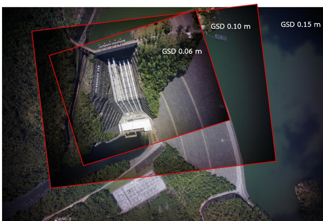
ภาพประกอบ 48 ตัวอย่างภาพถ่ายจากอากาศยานไร้คนขับที่ ความละเอียดจุดภาพบนพื้นดิน (GSD) 0.06 เมตร 0.10 เมตร และ 0.15 เมตร
