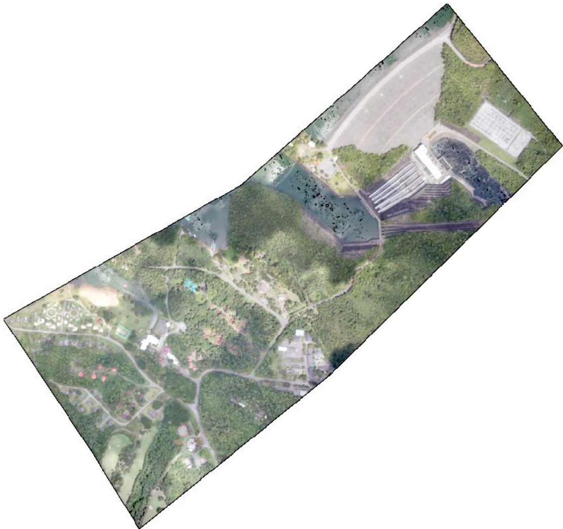
ภาพประกอบ 47 ภาพถ่ายออร์โธจากอากาศยานไร้คนขับที่ความละเอียดจุดภาพบนพื้นดิน (GSD) 0.15 เมตร
