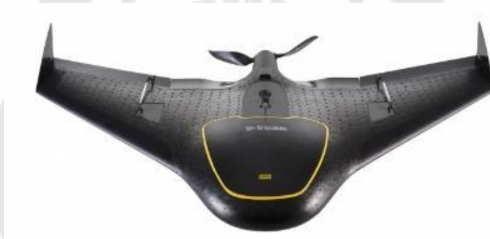
ภาพประกอบ 22 อากาศยานไร้คนขับประเภทปีกตรึงของ Trimble รุ่น UX5HP ที่ใช้เป็นเครื่องมือในการเก็บรวบรวมข้อมูล
