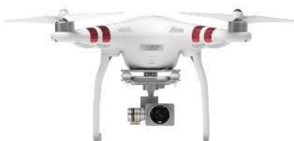
ภาพประกอบ 16 อากาศยานไร้คนขับแบบปีกหมุน (Multi-rotor)
