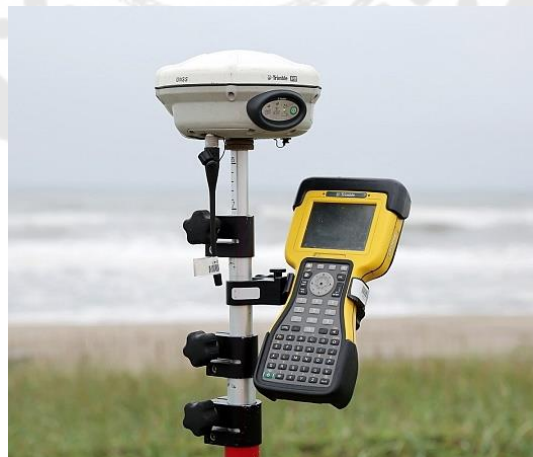
ภาพประกอบ 26 เครื่องรับสัญญาณดาวเทียม GNSS ของ Trimble รุ่น R8
