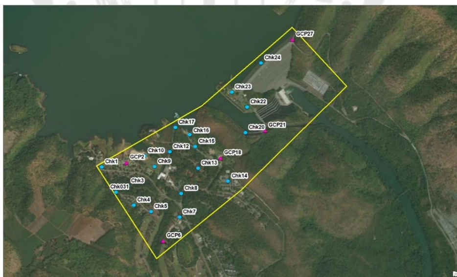
ภาพประกอบ 42 จุดวงกลมสีชมพูแสดงตำแหน่งจำนวนจุดควบคุมภาพถ่ายภาคพื้นดิน จุดวงกลมสีฟ้าแสดงตำแหน่งจุดตรวจสอบความถูกต้อง
