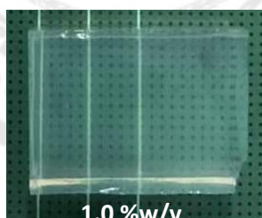
ภาพประกอบ 21 การขึ้นรูปวุ้นความเข้มข้นร้อยละ 1.0 ที่ 85-95 องศาเซลเซียส
