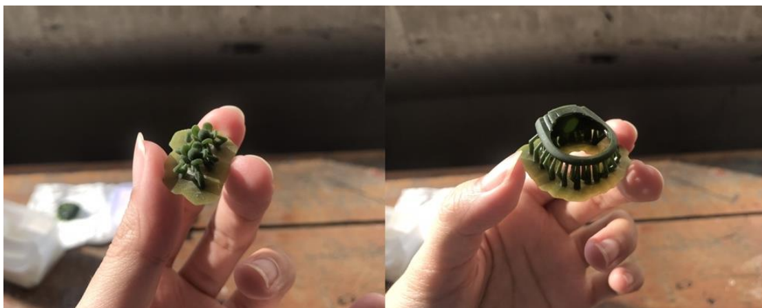
ภาพประกอบ 131 แวกซ์ของต้นแบบเครื่องประดับ ที่หล่อจากเครื่อง RP
