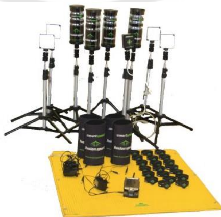
ภาพประกอบ 19 เครื่องมือวัดเวลาตอบสนอง (Response Time)
