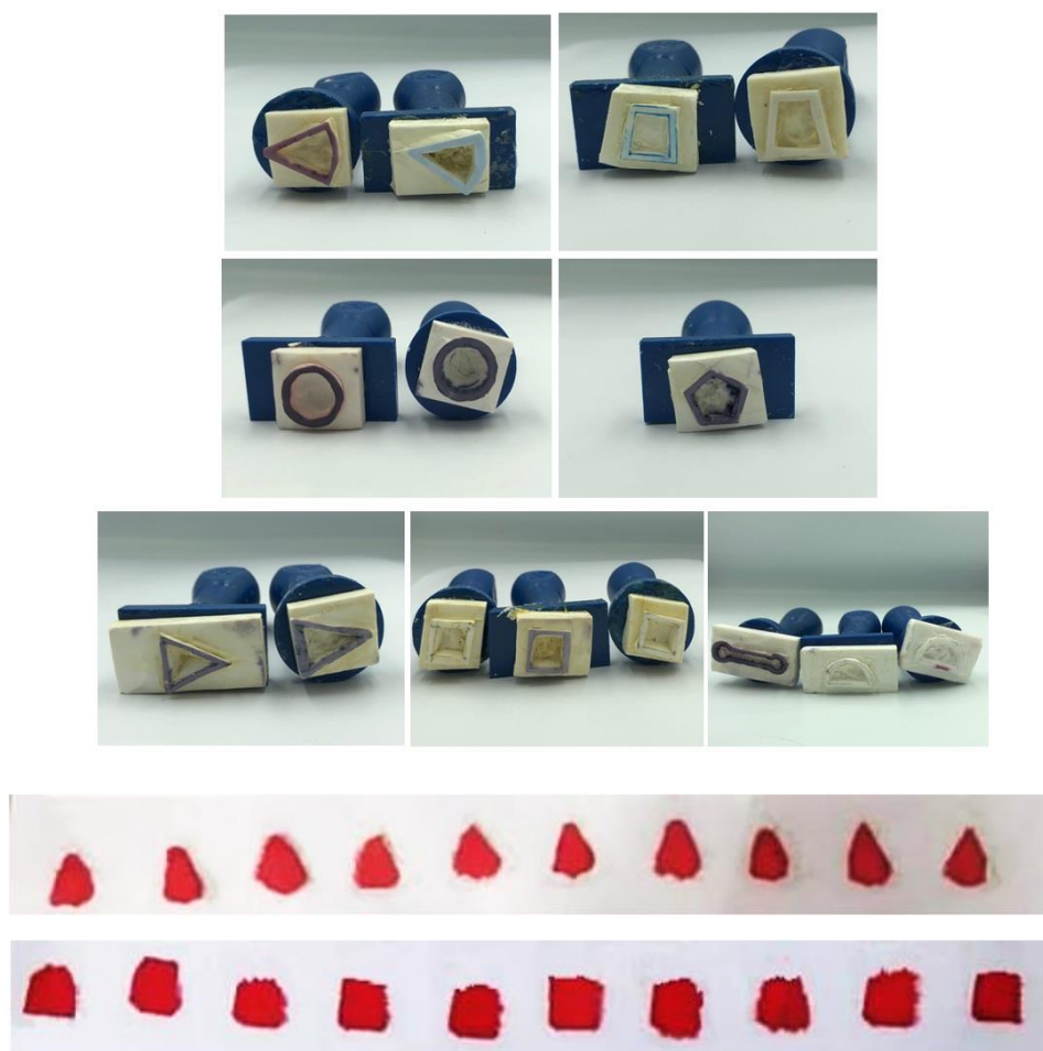
ภาพประกอบ 12 แม่พิมพ์และอุปกรณ์ตรวจวิเคราะห์ของไหลจุลภาคฐานกระดาษที่นิสิตสร้างขึ้น
