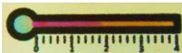
ภาพประกอบ 11 ตัวอย่างการใช้ \mu PADs ร่วมกับการตรวจวัดระยะทาง (Distance-based \mu PADs) เพื่อวิเคราะห์ปริมาณปรอท
