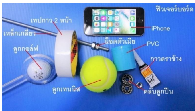
ภาพประกอบ 26 วัสดุอุปกรณ์การทดลองหาค่าสัมประสิทธิ์การกระดอน
