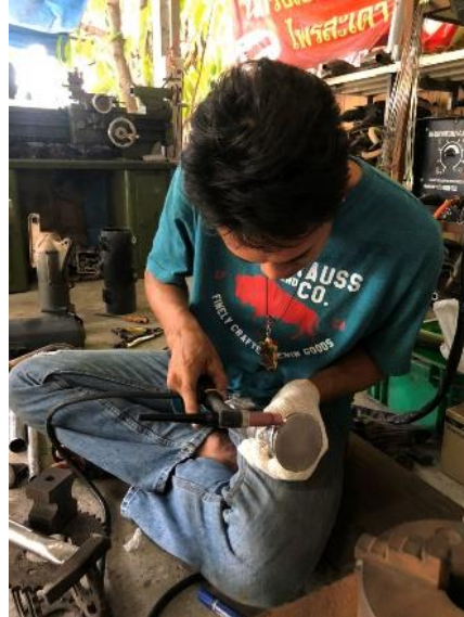
เชื่อมต่อดีด้วยวิธีการเชื่อมทิก (อากอน)
