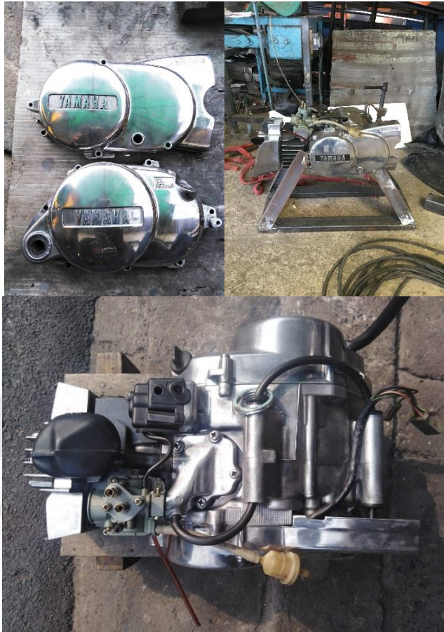
หลังทำความสะอาดเสร็จแล้วประกอบเครื่องยนต์และอะไหล่ทั้งหมดเข้าด้วยกัน
