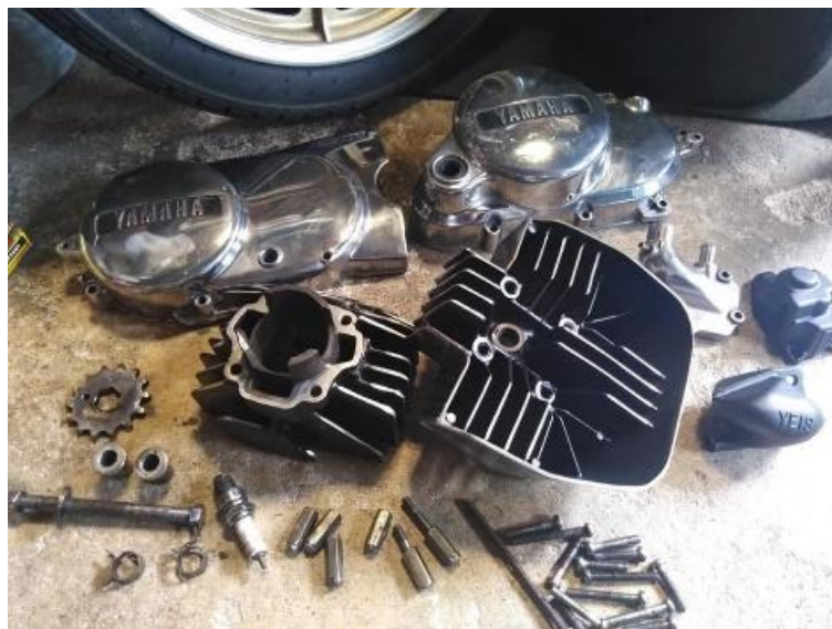
ภาพประกอบ 130 ทำความสะอาดเครื่องยนต์โดยทุกอย่างออกมาขัดใหม่
