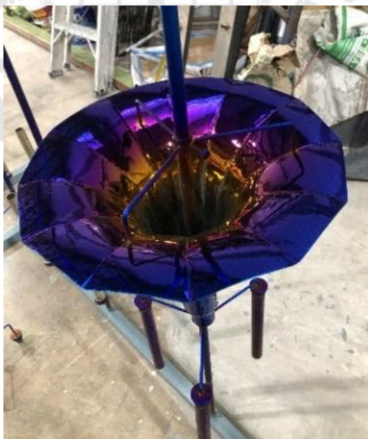
ภาพประกอบ 135 ทำสีโลหะระดับเจดสีรุ้งบนวัสดุเหล็กชุบโครเมียมเพื่อเลียนแบบสีไทเทเนียม
