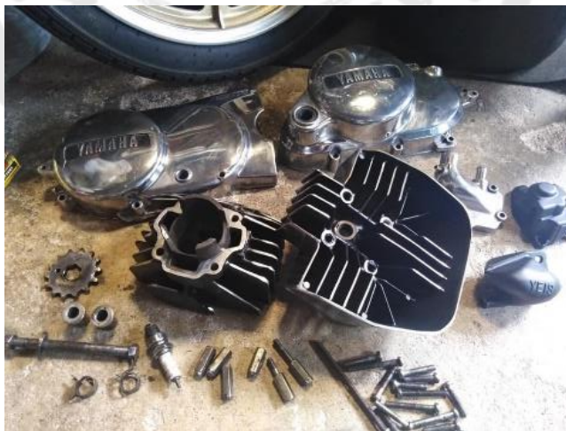
ถอดทุกอย่างออกมาล้างทำความสะอาดเครื่องยนต์และอะไหล่ทุกชิ้น
