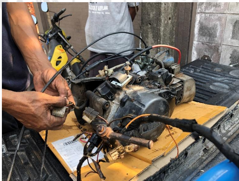
ภาพประกอบ 129 ขำแหละเครื่องยนต์เพื่อปลุกชีพให้กลับมาสตาร์ทได้อีกครั้ง
