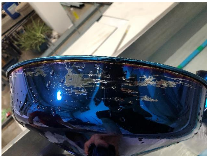
ภาพประกอบ 164 หลังจากผ่านกระบวนการทำสีมาพบว่าสีหลุดลอก
