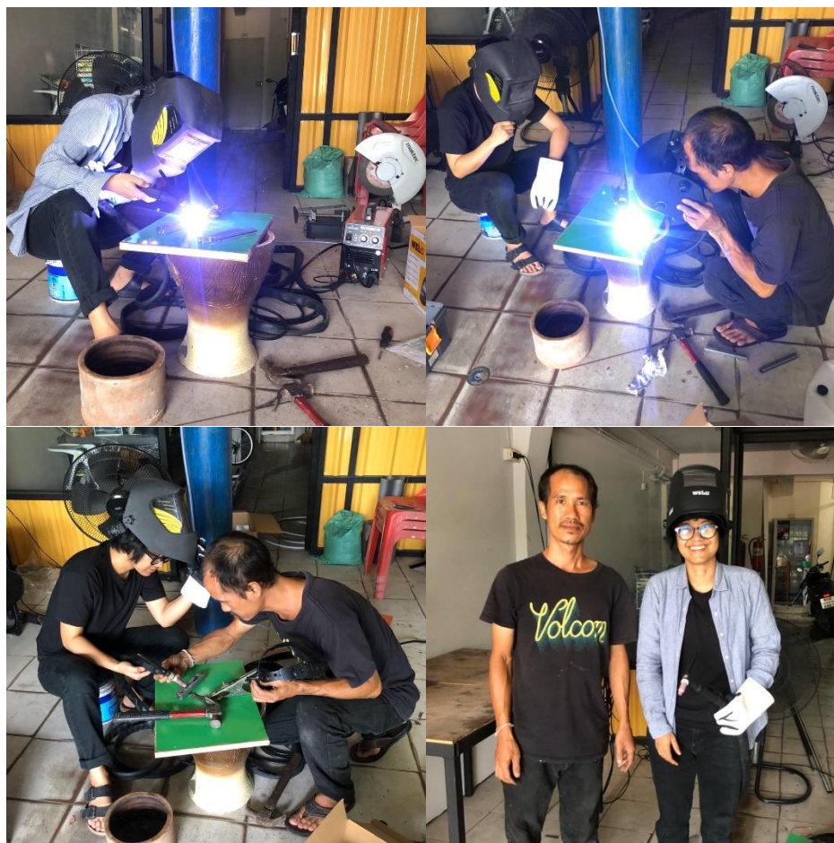
ภาพประกอบ 170 ผู้วิจัยได้ทดลองการเชื่อมทิกด้วยแก๊สอาากอน
