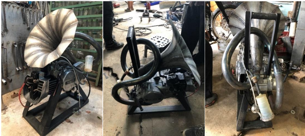
เชื่อมคอกท่อและท่อไอเสียขึ้นมาใหม่เป็นลำโพงทรงดอกชบาของเครื่องดนตรีสไตลวินเทจ
