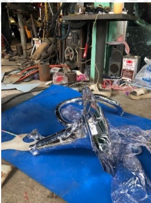
ภาพประกอบ 133 นำไปชุบโครเมียมเพื่อเตรียมผิวสำหรับทำสีรุ้ง
