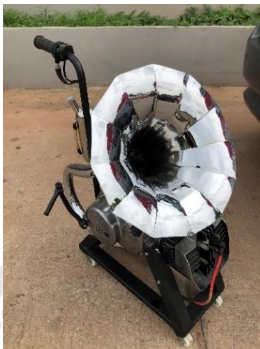
ภาพประกอบ 134 ปรับโครงสร้างสร้างเสาะเพิ่มทางด้านหลังเครื่องยนต์ติดปลอกแฮนด์ใส่คันเร่ง ติดตั้งถังน้ำมัน โดยใช้น้ำมันถังเดียวต้องผสมออกได้ดูกับน้ำมันเชื้อเพลิงเข้าด้วยกันก่อนใส่
