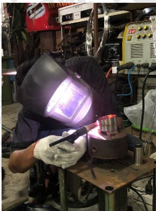
ภาพประกอบ 143 เชื่อมท่อไทเทเนียมที่ตัดไว้เข้าด้วยกันด้วยวิธีเชื่อม
