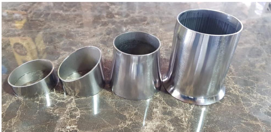
ภาพประกอบ 142 เตรียมพื้นผิววัสดุโดยการขัดให้เรียบให้เงา
