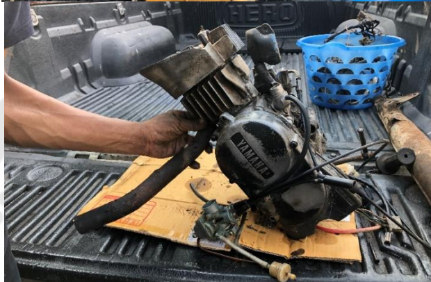
เมื่อรื้อถอดเครื่องยนต์ออกจากโครงมอเตอร์ไซค์แล้ว เก็บชิ้นส่วนอะไหล่ สายไฟในส่วนที่ต้องใช้ให้ครบ
