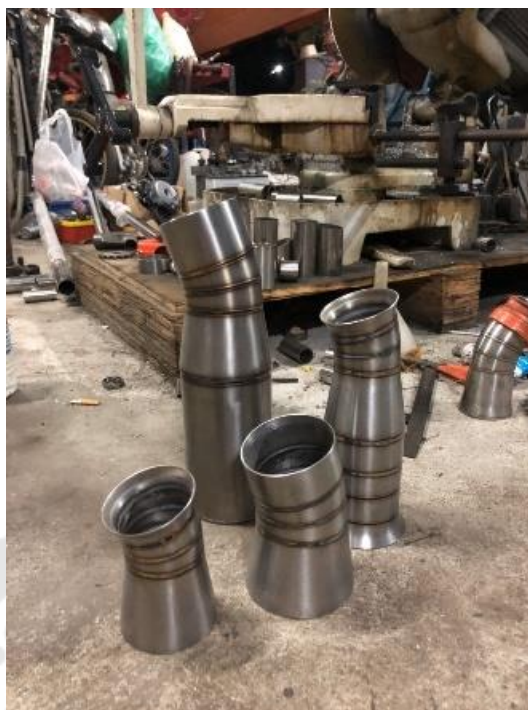
ภาพประกอบ 144 เชื่อมทุกข้อต่อและเชื่อมปิดปลายท่อ
