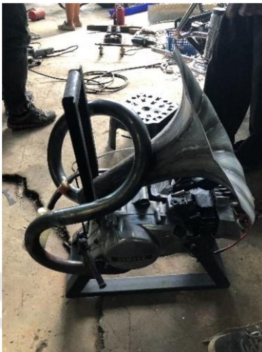
ภาพประกอบ 132 เชื่อมต่อคอกท่อให้พันเลื่อยมาออกท่อไอเสีย ที่เชื่อมเป็นทรงลำโพงเครื่องดนตรีสไตลวินเทจ
