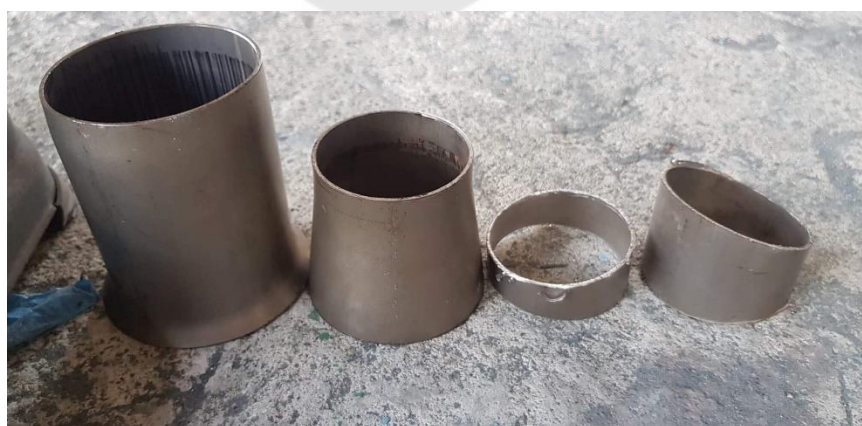
ภาพประกอบ 141 นำท่อไทเทเนียมตัดท่อออกเป็น 4 ส่วน
