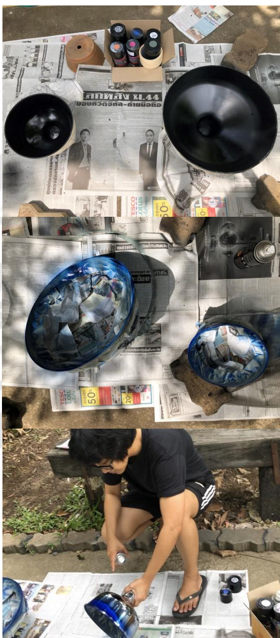
ภาพประกอบ 166 ตรงส่วนที่มีคราบน้ำมันปนสีสเปรย์ไม่ติด
