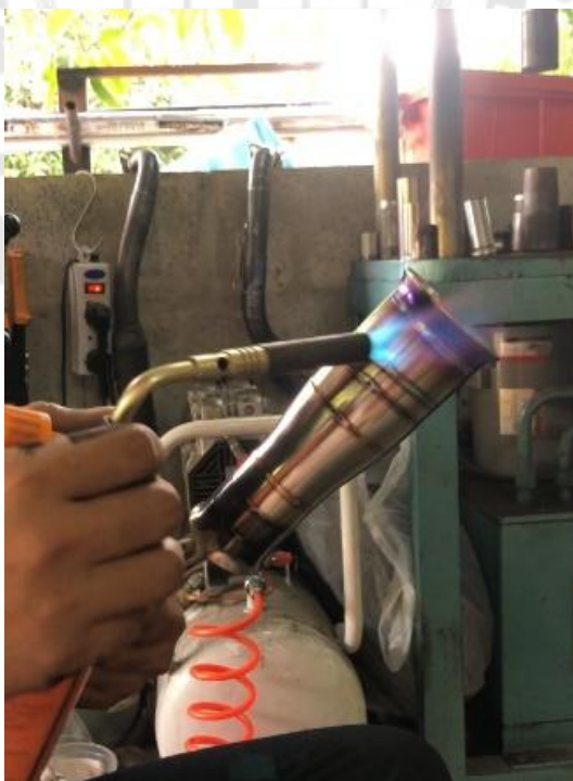
ภาพประกอบ 145 ทำสีด้วยการเผาด้วยความร้อน
