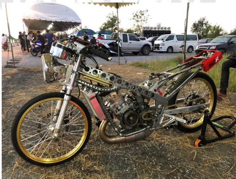
ภาพประกอบ 84 ลักษณะการถอดเฟืองออกทั้งหมดเพื่อให้ถมีน้ำหนักเบา
