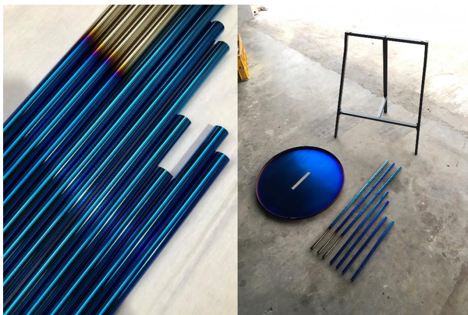
ภาพประกอบ 171 วัสดุสแตนเลสนำมาทำสีเลียนแบบสีเทเทเนียมของแท้
