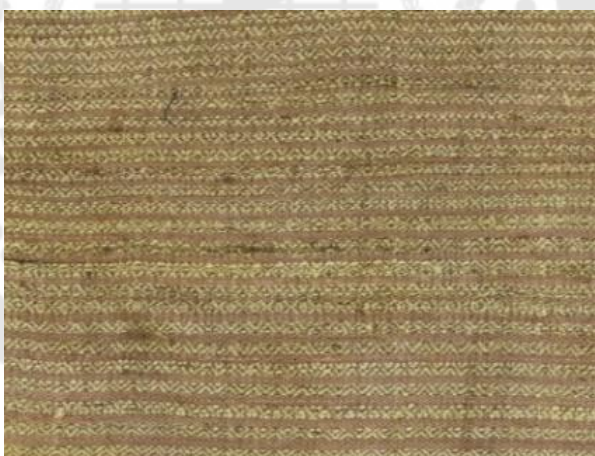
ภาพประกอบ 49 รูปแบบผืนผ้าทอตามอัตราส่วนการทอของไหมต่อเส้นใยสับปะรดที่ 70:30
