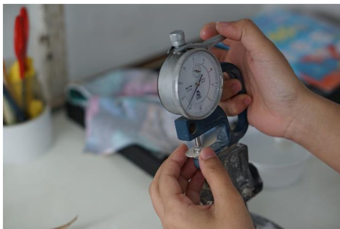
ภาพประกอบ 57 การตรวจสอบความหนาของเปลือกหอยมุก
