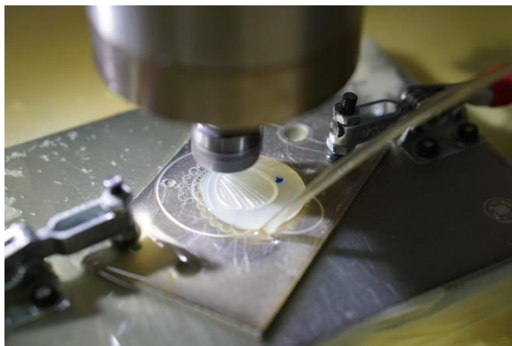
ภาพประกอบ 55 หัวตัดทำการเจาะลายบนเปลือกหอยมุก
