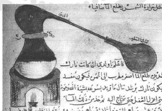
ภาพประกอบ 2 อุปกรณ์สำหรับการทดลองการกลั่นมีชื่อว่า “Alembic”
