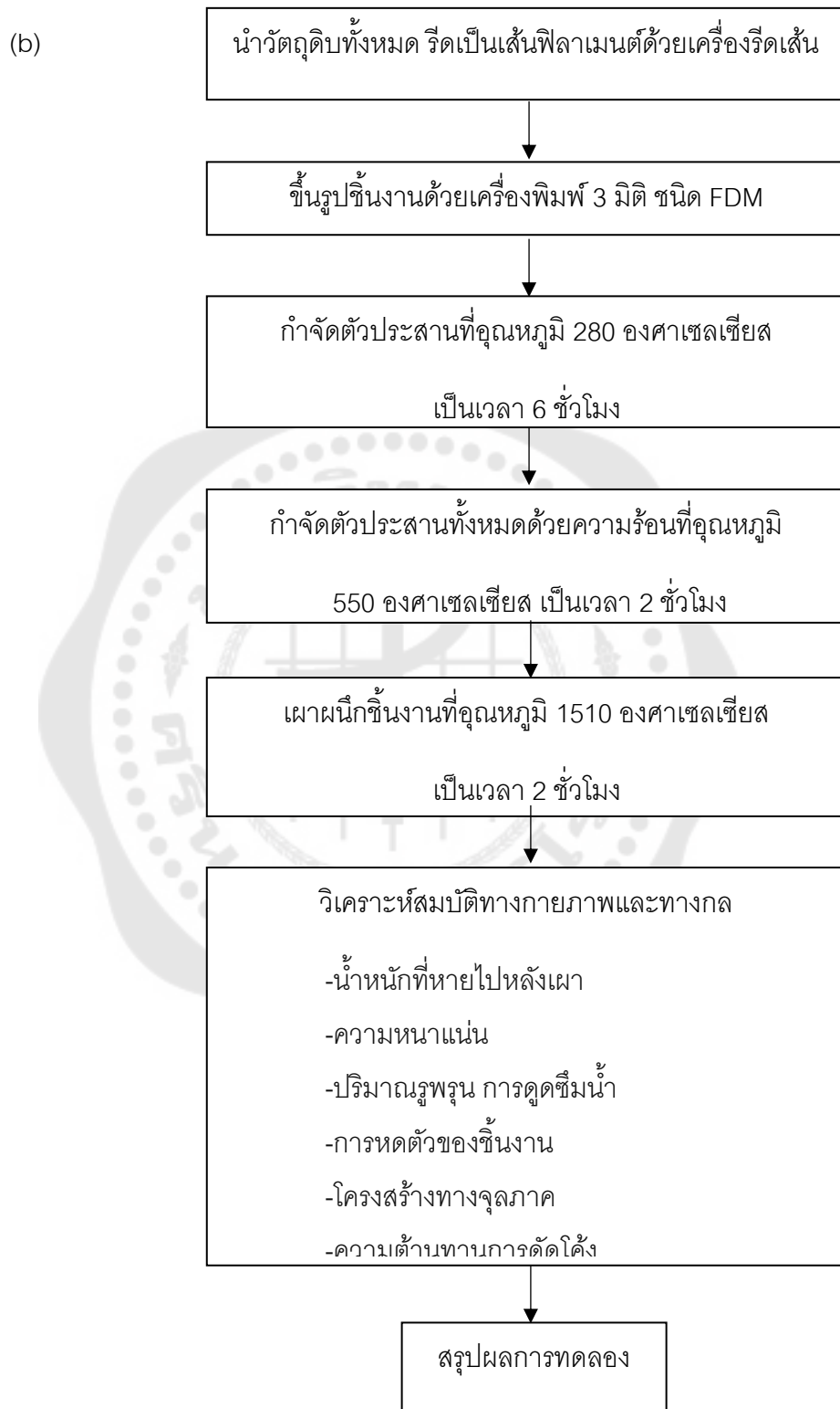
ภาพประกอบ 19 แผนผังงานวิจัยการเตรียมเซรามิกเซอร์โคเนีย ด้วยเทคนิคการพิมพ์ 3 มิติ (a) ขั้นตอนการผสมส่วนผสม (b) ขั้นตอนหลังจากการผสมส่วนผสม
