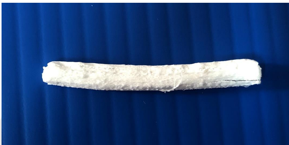
ภาพประกอบ 32 ภาพชิ้นงานหลังการเผาที่มีการโค้งงอและการแยกชั้น
