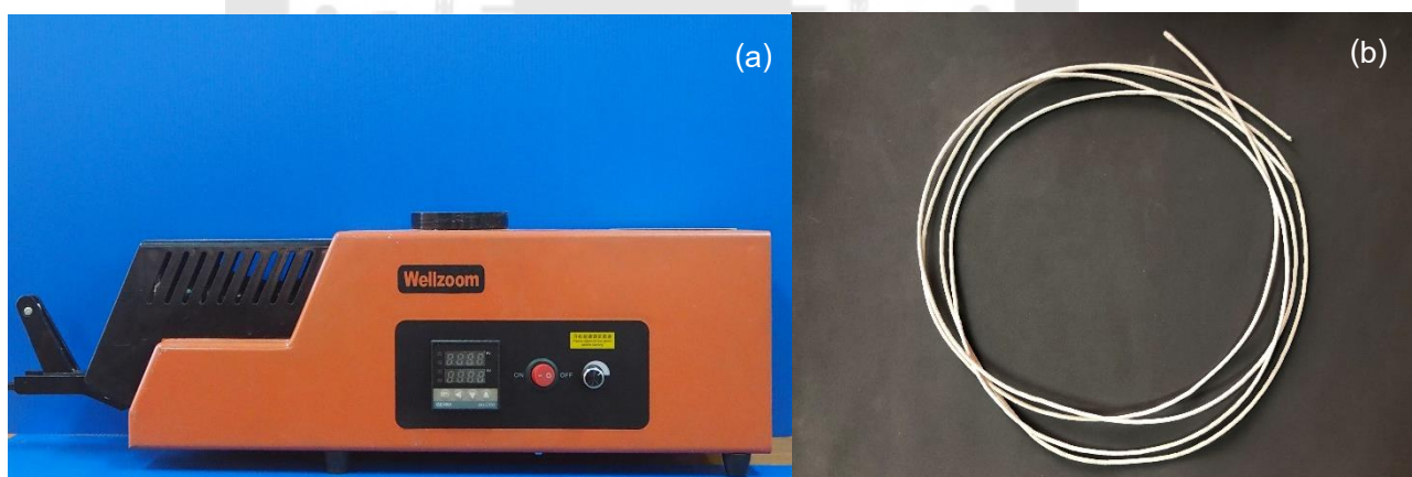
ภาพประกอบ 23 แสดง (a) เครื่องขึ้นรูปฟิลาเมนต์ (b) ฟิลาเมนต์ที่ผ่านการฉีดขึ้นรูป
