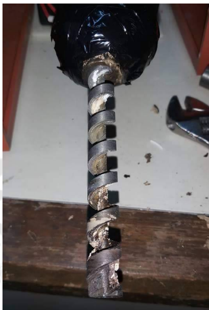
ภาพประกอบ 34 สกรูภายในเครื่องรีดเส้นฟิลาเมนต์ที่เกิดการหลุดตัน
