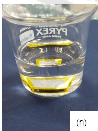
ภาพประกอบ 17 แสดงการเตรียมพื้นผิวขรุขระระดับนาโนเมตร (ก) จุ่มชิ้นงานในสารละลาย KOH (ข) ต้มในน้ำปราศจากไอออน
