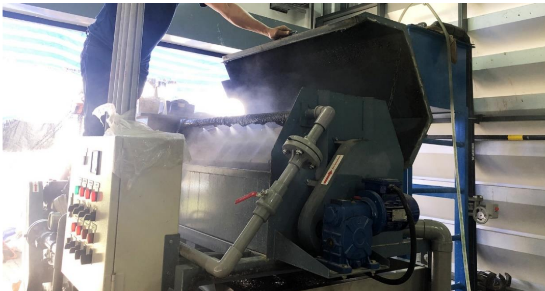
ภาพประกอบ 15 การนำน้ำที่ผ่านกระบวนการกรองไปล้างเครื่องจักร
