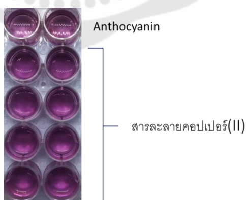
ภาพประกอบ 14 แสดงสีของสารละลายคอปเปอร์(II) ไอออน ที่ความเข้มข้น 1.71 มิลลิกรัมต่อลิตร (n=8)
