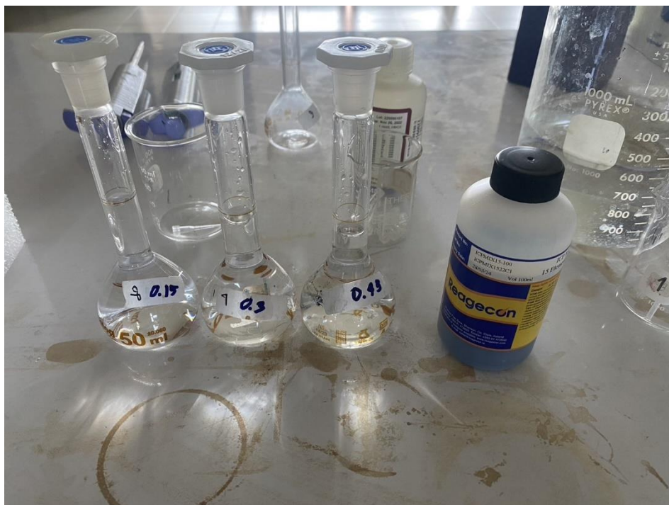
ภาพประกอบ 18 การเตรียมสาร standard เพื่อนำไปวิเคราะห์ด้วยเครื่อง ICP-OES
