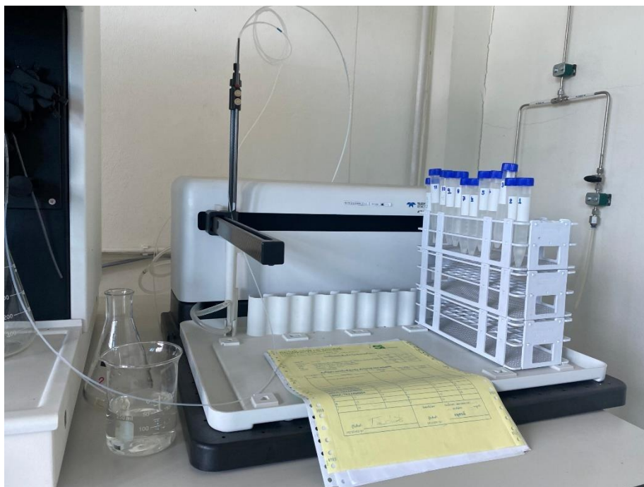
ภาพประกอบ 19 การวิเคราะห์ด้วยเครื่อง ICP-OES
