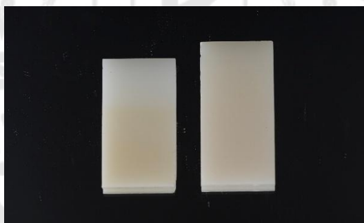
ภาพประกอบ 14 แสดงชิ้นงานเซอร์โคเนียไล่ระดับความโปร่งแสงหลังการเผาและทำการเคลือบผิวเซรามิกแล้ว ยี่ห้อคาทานะ วายเอ็มแอล (ภาพซ้าย) และนาเซรา เพิร์ล เนเซอร์ล (ภาพขวา)
