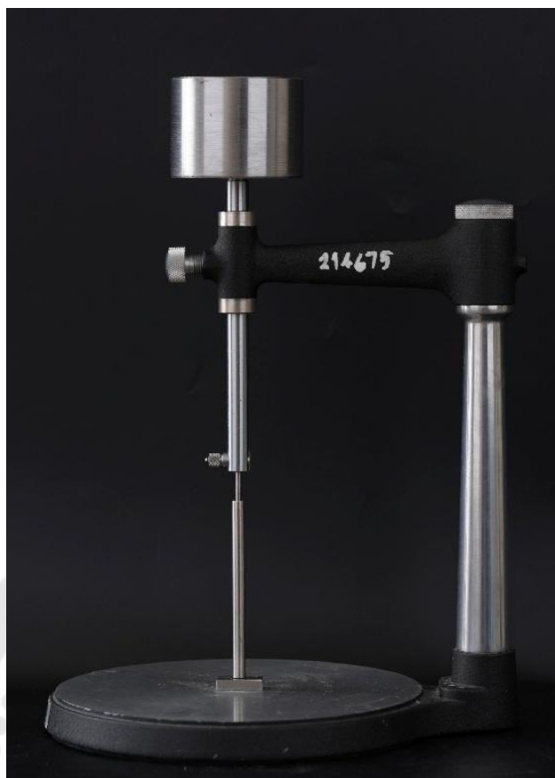
ภาพประกอบ 18 แสดงเครื่องช่วยออกแบบงานทันตกรรมประดิษฐ์ที่ใช้ในการทดลอง
