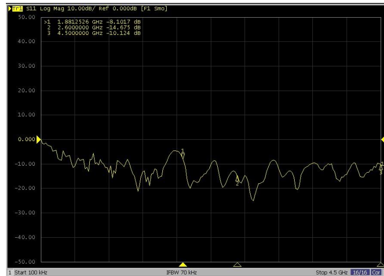
ภาพประกอบ 29 ค่า S_{11} ของสายอากาศรูปทรงก้นหอยที่มีการสวิตช์ลาคี่รูปแบบที่ 1
