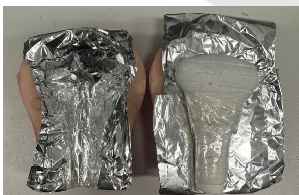
ภาพประกอบ 16 การอัดแผ่นฟอยล์อลูมิเนียมลงบนแม่พิมพ์ให้เป็นรูปร่างผนังมดลูก
