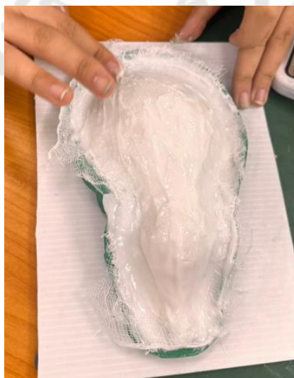
ภาพประกอบ 9 ทาซิลิโคนให้ทั่วบริเวณแม่พิมพ์ จากนั้นแปะผ้าก๊อซเพิ่มความแข็งแรง
