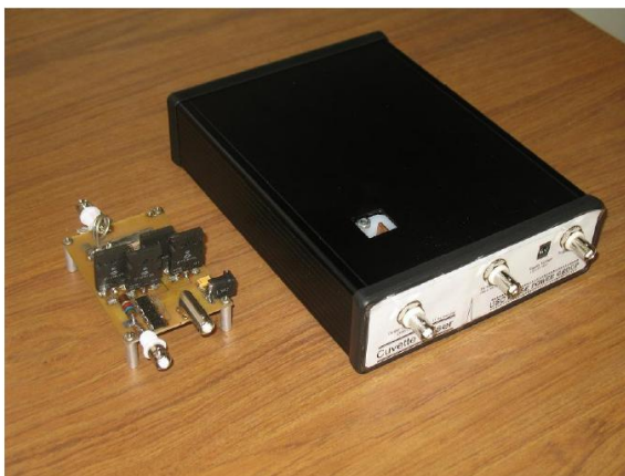
ภาพประกอบ 12 เครื่องกำเนิดพัลส์นาโนวินาทีที่มีขนาดเล็กและจุดสำหรับใส่หลอดทดลองเพื่อทดสอบสนามไฟฟ้าพัลส์นาโนวินาที
