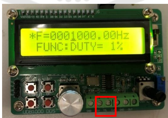
ภาพประกอบ 38 เครื่องกำเนิดสัญญาณพัลส์ที่ทีแอล (TTL signal) สำหรับควบคุมการทำงานของมอสเฟต
